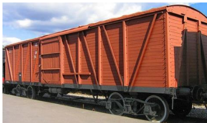
Рисунок 2.20 – Общий вид универсального четырехосного крытого вагона
