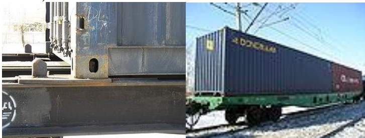
Рисунок 2.23 – Вид фитингового упора и контейнер на фитинговой платформе
