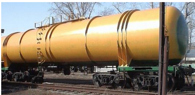
Рисунок 2.25 – Общий вид восьмиосной цистерны для перевозки нефтепродуктов
