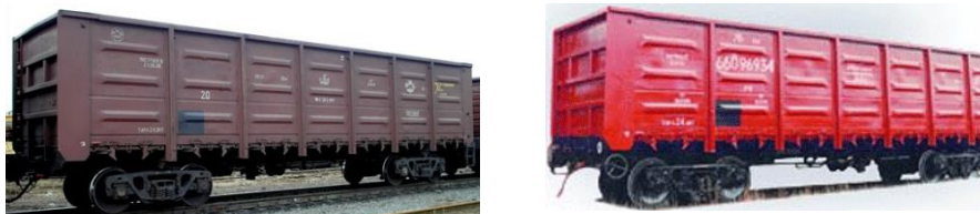
Рисунок 2. 24– Общий вид универсального четырехосного полувагона с глухими торцовыми бортами
