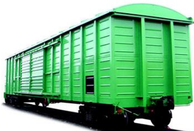
Рисунок 2.20 – Общий вид универсального четырехосного крытого вагона
